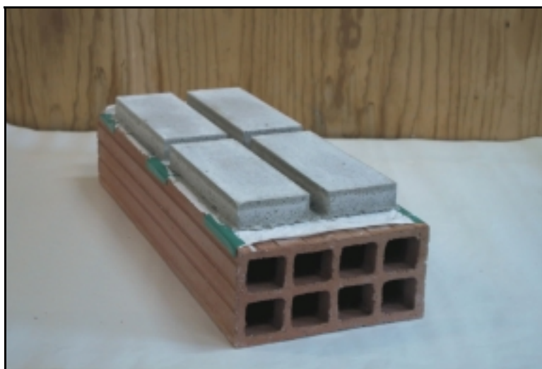
Figura 4.32 – Fotografia dos corpos-de-prova de argamassa aplicada sobre bloco cerâmico e papel-filtro, após a retirada da forma.
