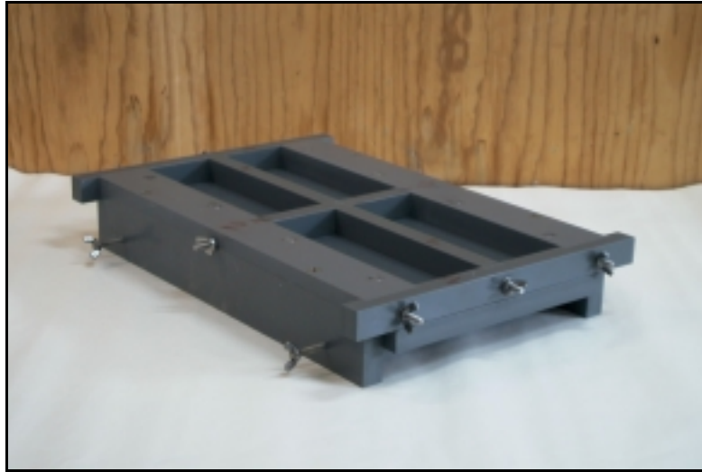
Figura 4.27 – Fotografia de molde em PVC para fabricação de corpos-de-prova de argamassa para ensaios mecânicos. O fundo removível do molde serve como base não-absorvente para as moldagens do Caso I.
