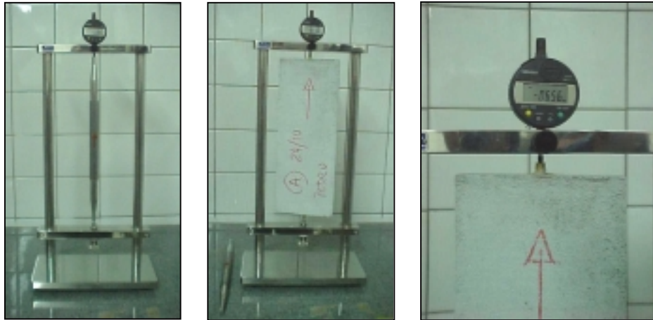
Figura 4.22 - Fotografias do ensaio de retração de placa de argamassa no estado endurecido – posicionamento da barra-padrão para obtenção da leitura inicial "zero" no relógio comparador e leitura do comprimento da placa.
