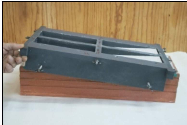
Figura 4.31 - Fotografia da operação de desmoldagem dos corpos-de-prova de argamassa do conjunto molde-bloco cerâmico do Caso III.
