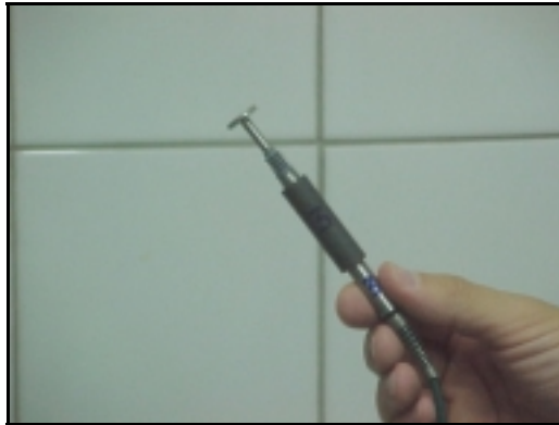
Figura 4.11 – Fotografia de um captor de deformação tipo digital, de curso máximo 2,5 mm e precisão 0,001 mm.
