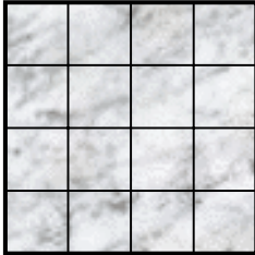
FIGURA 105 – ILUSTRAÇÃO MOSTRANDO O ASSENTAMENTO DE PEÇAS COM JUNTAS EM CRUZ
