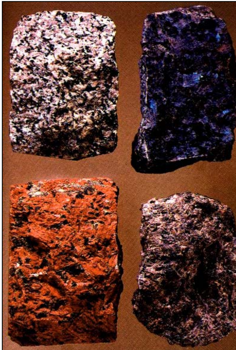
FOTO 45 - BLOCOS BRUTOS DE SIENITO (COM DIMENSÕES APROXIMADAS DE 4x7 cm). A AMOSTRA SUPERIOR DIREITA É UM LARVIKITO COM COR E REFLEXO TÍPICO AZULADO (AHILHERIZAÇÃO) (Fonte: Schumann, W., 1985)
