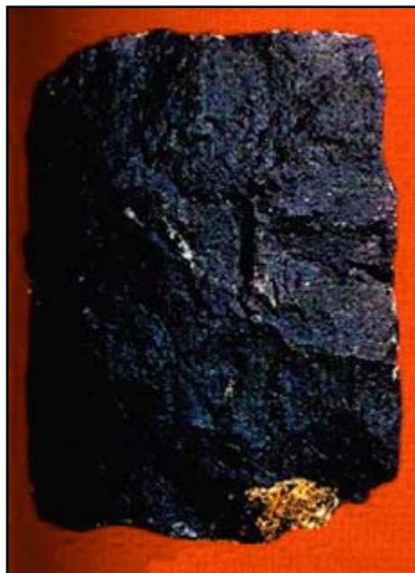
FOTO 33 - FOTO DE UM BLOCO DE BASALTO EM ESTADO BRUTO (10x7 cm) (Fonte: Schumann, W., 1985)
