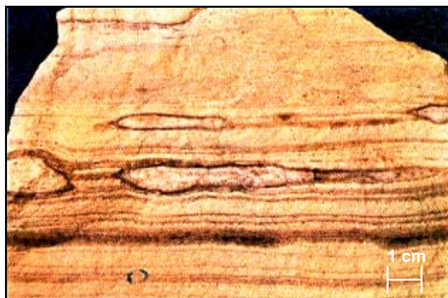
FOTO 49 - PLACA BRUTA DE CALCÁRIO COM ESTRUTURAS SEDIMENTARES (Fonte: Bigarella, J. J.; Leprevost, A.; Bolsanello, A., 1985)
