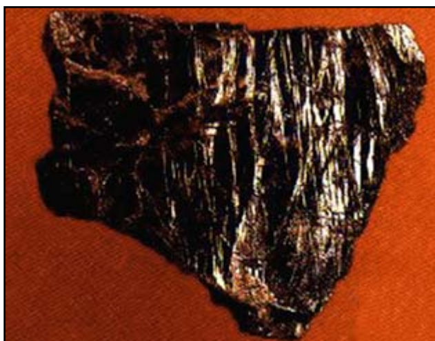
FOTO 19 - FOTO DE "LIVRO" (MINERAL ESPESSO) DE BIOTITA MOSTRANDO PLANOS DE CLIVAGEM (Fonte: Schumann, W., 1985)
