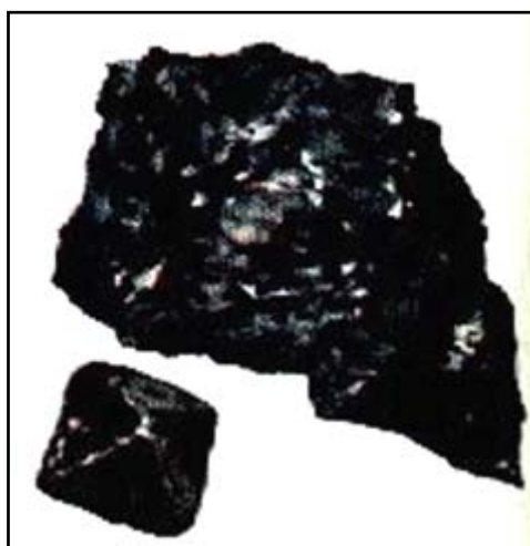
FIGURA 39 - DESENHO DE AGREGADO DE MAGNETITA. NO DETALHE: MINERAL COM HÁBITO OCTAÉDRICO (Fonte: Zim, H. S.; Sahffer, P. R., 1957)
